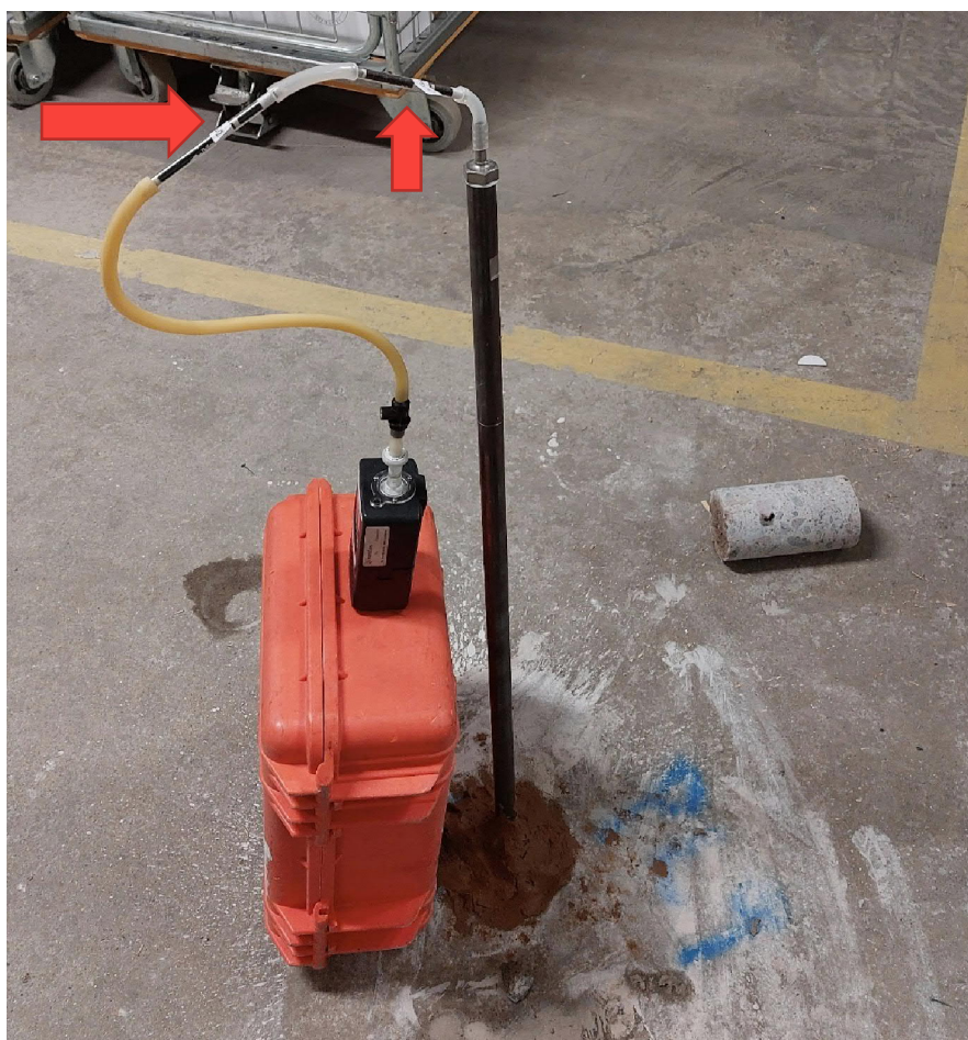
Figur 8. Provtagning av porluft i grund sond. De röda pilarna pekar mot adsorbenttrören.
