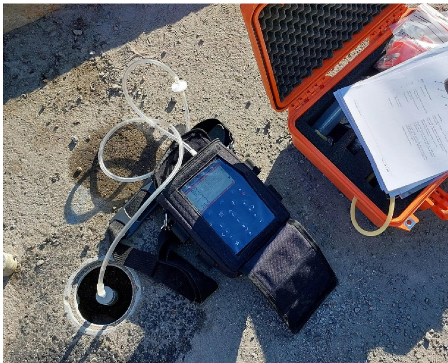
Figur 9. Biogasmätning i djup porluftsond.
