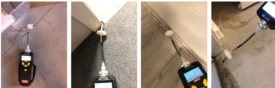
Figur 5: Fotos af målinger med PID-detektor
