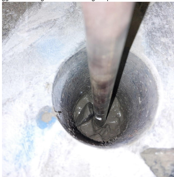
Figur 5. Hål i betongplatta och underliggande lager av sandig makadam. Fuktigheten bedöms härröra från kylvattnet som användes i samband med betonghåltagning. Metallröret som stuckits ned i hålet är sonden som användes vid porluftprovtagning.
